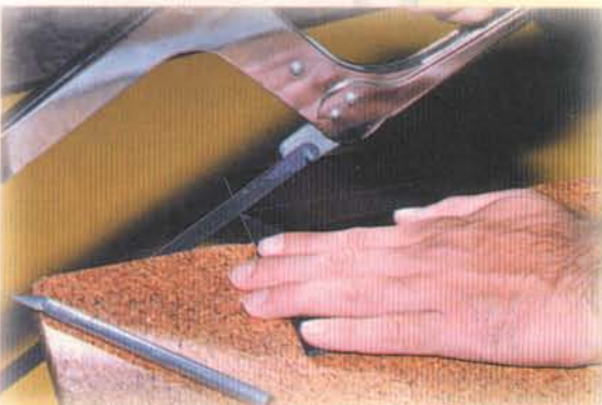
Figura 8.15. Corte manual de piezas de acrílico
